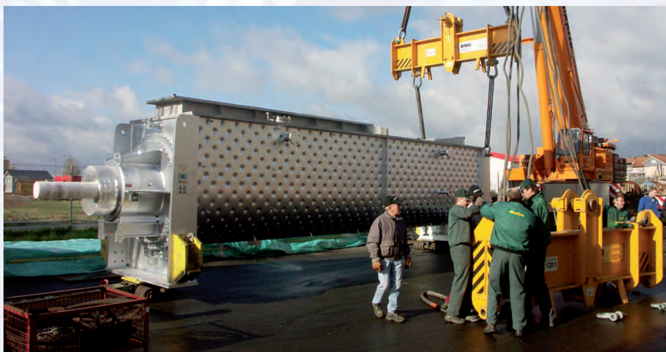
Погрузка аппарата ROVACTOR®, предназначенного для сушки терефталиевой кислоты
