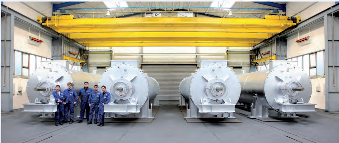
Четыре горизонтальных пленочных сушильных аппарата для поставки в Китай
