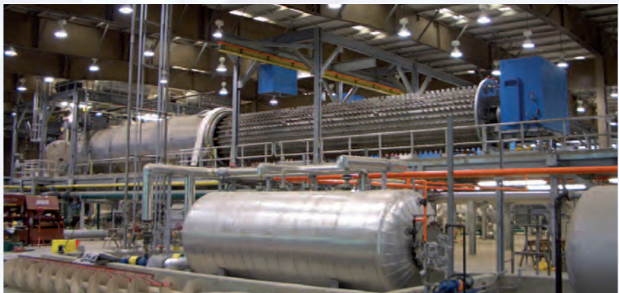
Аппарат для сушки шламов с выдвинутым ротором
