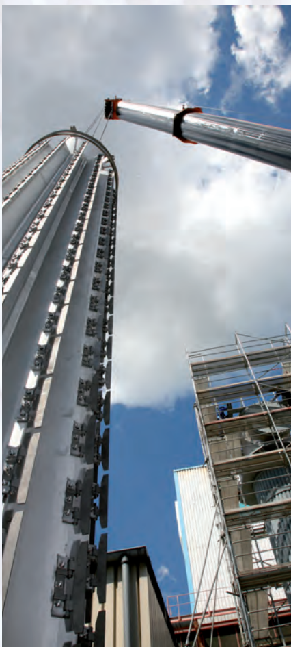
Сушильный аппарат CP на внешнем испытательном стенде
